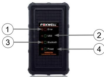
Figure 2-5 Vue de face du dongle VCI
